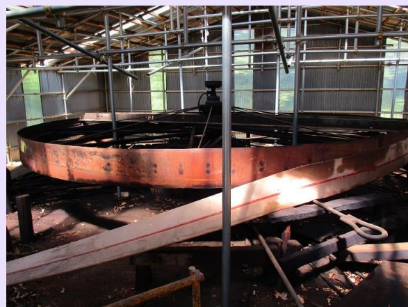
現存する唯一の「原油汲み上げポンプと動力機」
